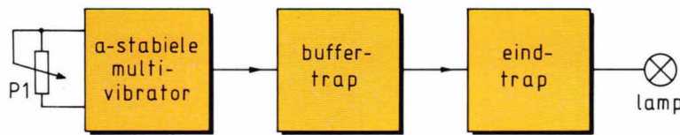
Fig. 1. Een a-stabiele multivibrator (AMV) zorgt voor een soort pulsbreedtemodulatie, waardoor het dimmeffect wordt verkregen. Uiteraard is dit niet helemaal waar en gaat ook de frequentie van het signaal mee op en neer.
